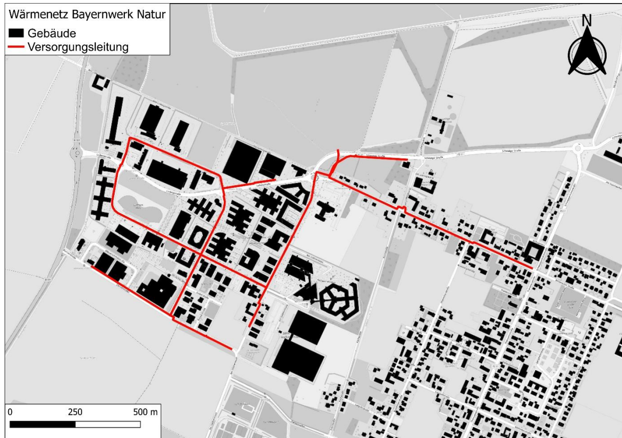
Abbildung 7: Hauptversorgungsleitungen des Bestandswärmenetzes in Hallbergmoos. Quelle: Bayernwerk Natur
