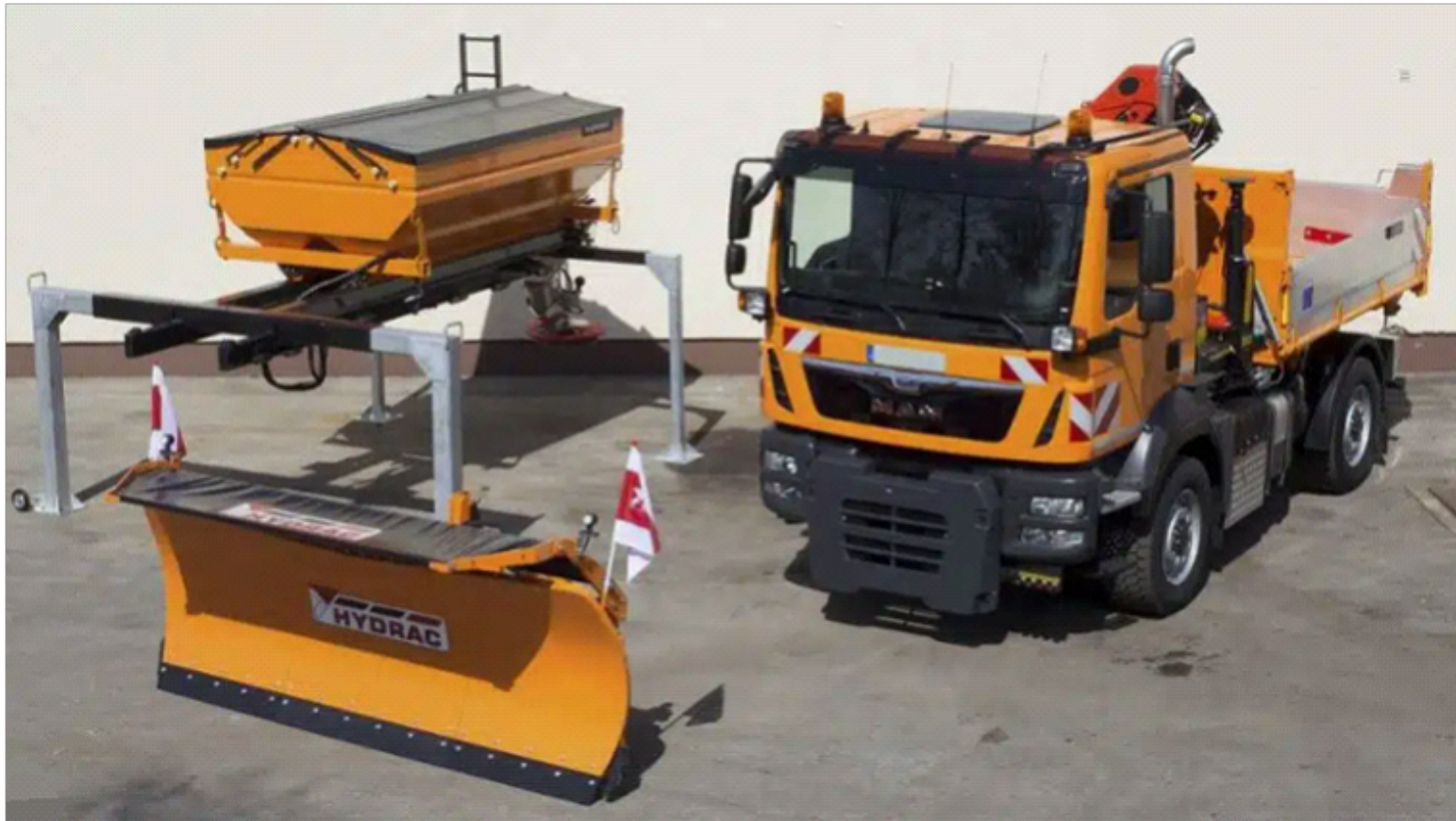
Beispielbild Kommunal-LkW 2-Achser mit Winterdienstausstattung und Ladekran
